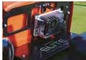
ELITE リチウムバッテリー & オンボード高周波 18 amp 48V DC 出力、85 ~ 265V AC 45 ~ 65 Hz 入力
